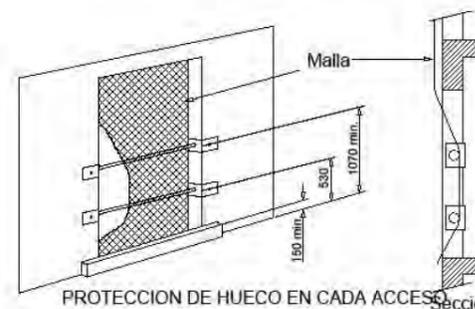
EL CLIENTE DEBE PROPORCIONAR UNA PROTECCIÓN SIMILAR A LA DESCRITA EN EL DIBUJO EN TODOS LOS ACCESOS MIENTRAS DURE LA INSTALACIÓN DEL APARATO. LA PROTECCION DEBERÁ SER CAPAZ DE SOPORTAR UNA FUERZA HORIZONTAL DE 90KG APLICADA DESDE EL EXTERIOR DEL HUECO
